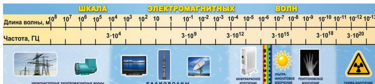
*Частотный диапазон электромагнитных излучений*
